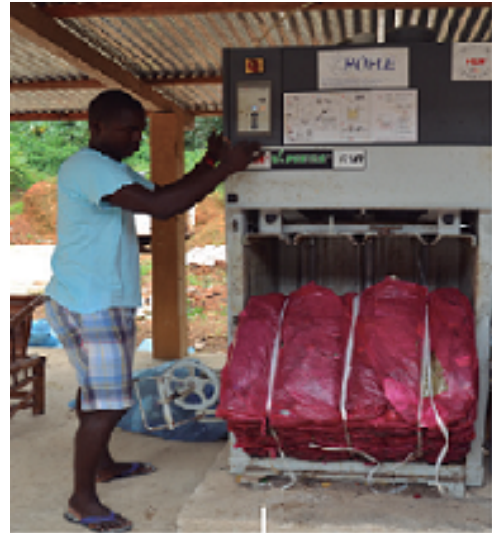
Compactage du plastique collecté
