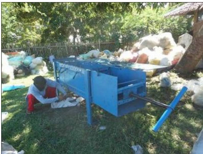
Compresseur pour les filets de pêche conçu localement
