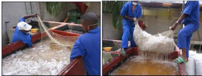
Les plastiques sont lavés dans des grandes cuves de ce type
