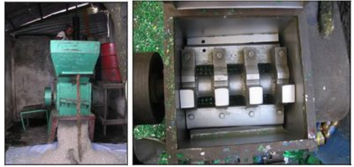
Un broyeur rapide est utilisé pour couper la matière en morceaux de 12 mm de diamètre ou de rayon (c
