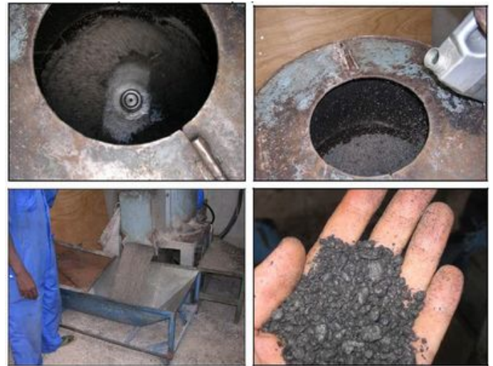
Phase d'agglomération des confettis plastiques
